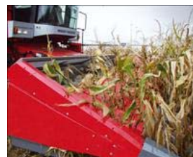
Høst af kernemajs med et plukkebord i stedet for et alm. skærebord giver større kapacitet, mindre spild og mindre snavs i mejetærskeren. Foto: Ken Brink, Sønderjysk Landboforening
